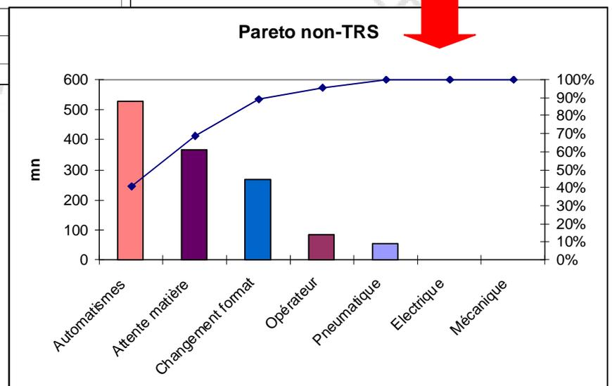
La cause majeure des pertes enregistrées est liée aux arrêts et pannes engendrés par les automatismes.
